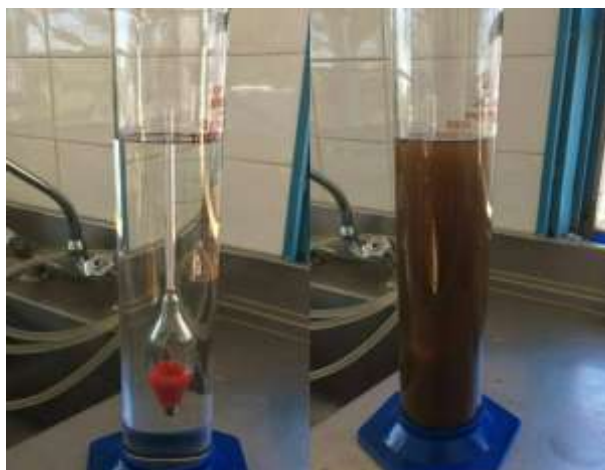
FIGURA 4. Provetas com amostras de solo suspensas em água e dispersante e uso de hidrômetros para determinação da textura do solos.
