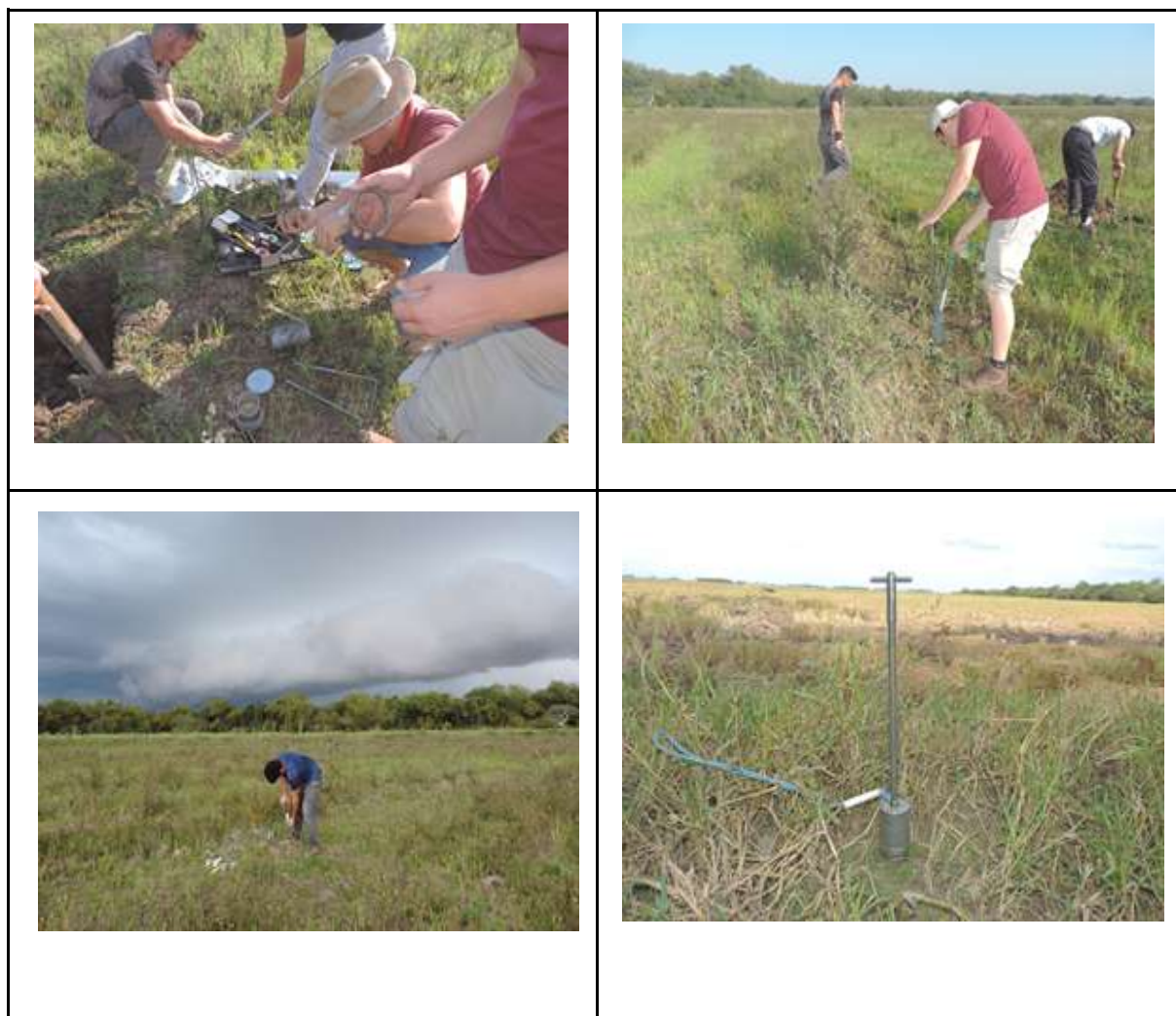
FIGURA 3. Coleta de amostras com anéis de Kopeck e amostrador de Uhland para determinação da densidade do solo.
