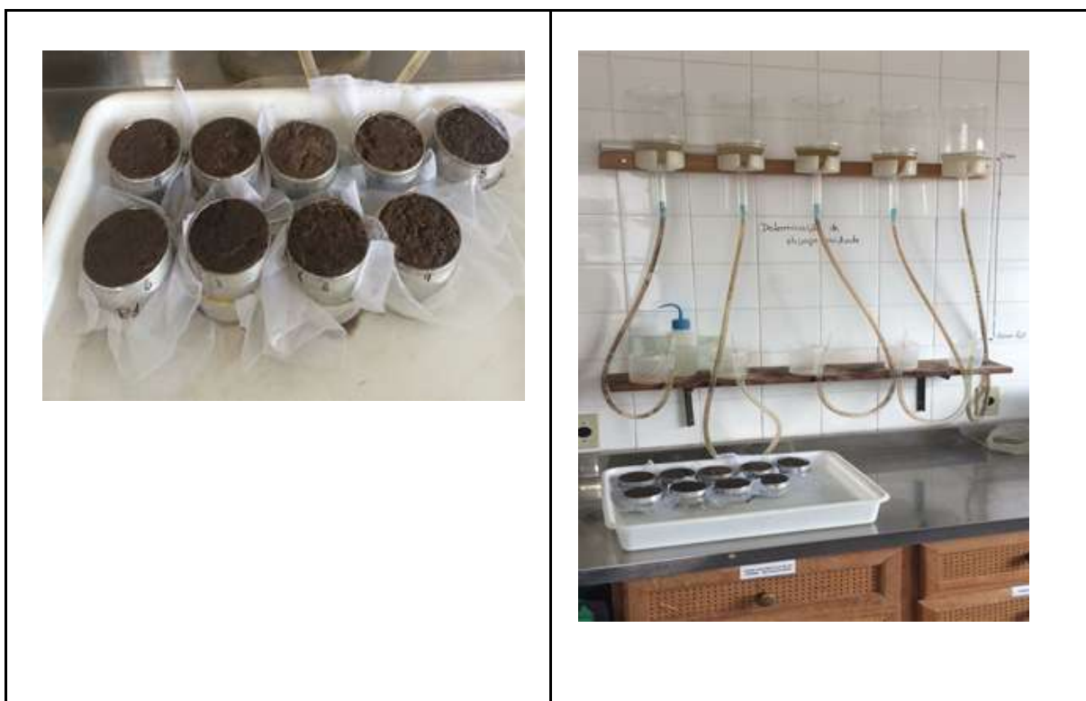
FIGURA 5: Anéis de solos em saturação (direita) e no funil de placa porosa (esquerda) para determinação da microporosidade
