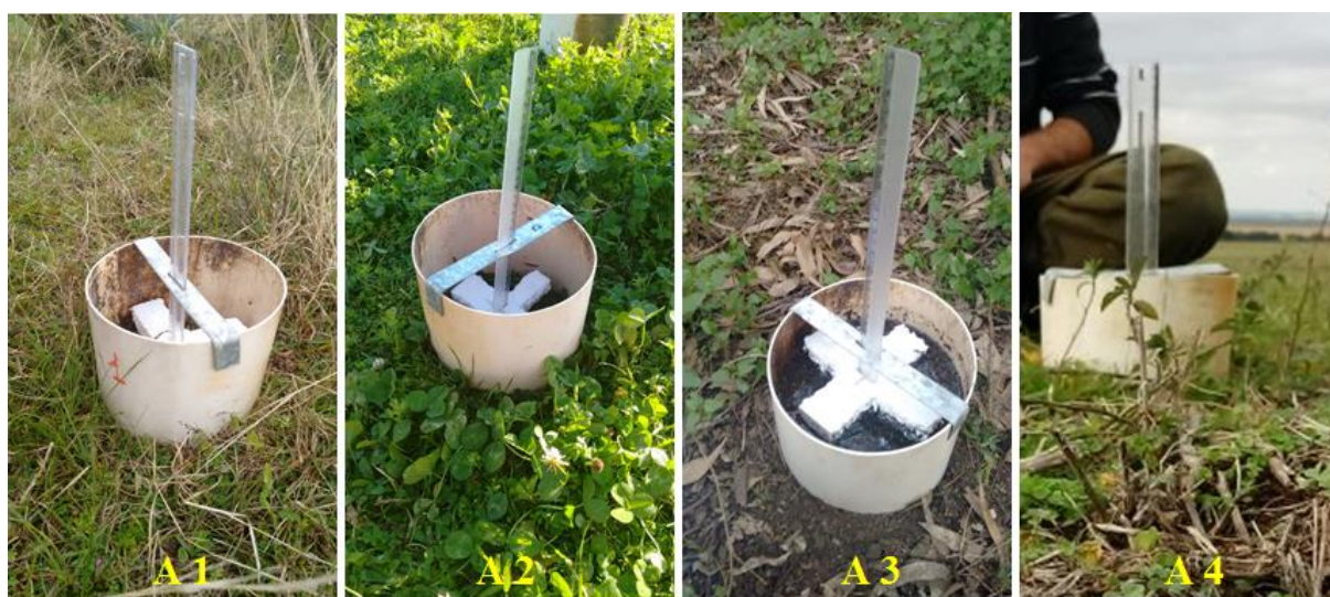
Figura 3: Ensaios com anéis de infiltrômetro simples em cada área.
