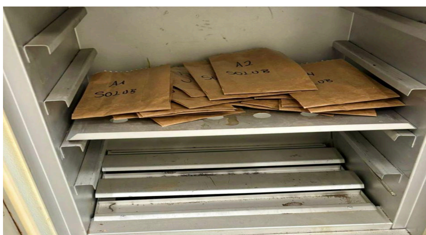
Figura 5- Amostras da cultura do trigo na estufa a 60°C para a secagem
