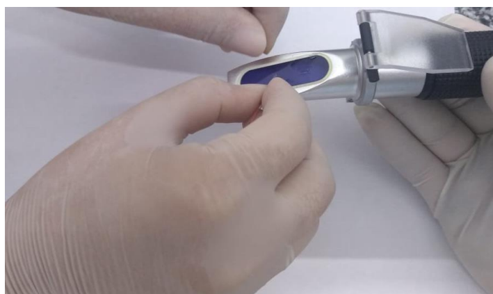
Figura 5: Preenchimento do refratômetro com plasma do tubo capilar.
